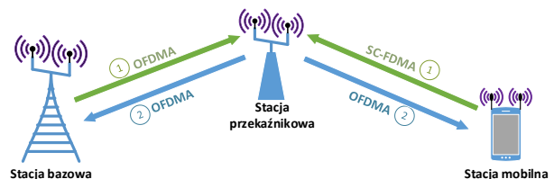
Rys. 1. Model rozważanego systemu.
